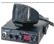
**RADIO VEICOLARI:** apparati che si installano a bordo degli automezzi, necessitano di una fonte di alimentazione esterna, di un'antenna, di un microfono e di un altoparlante. Il corpo centrale contiene i circuiti di sintonia, ricezione e trasmissione.
